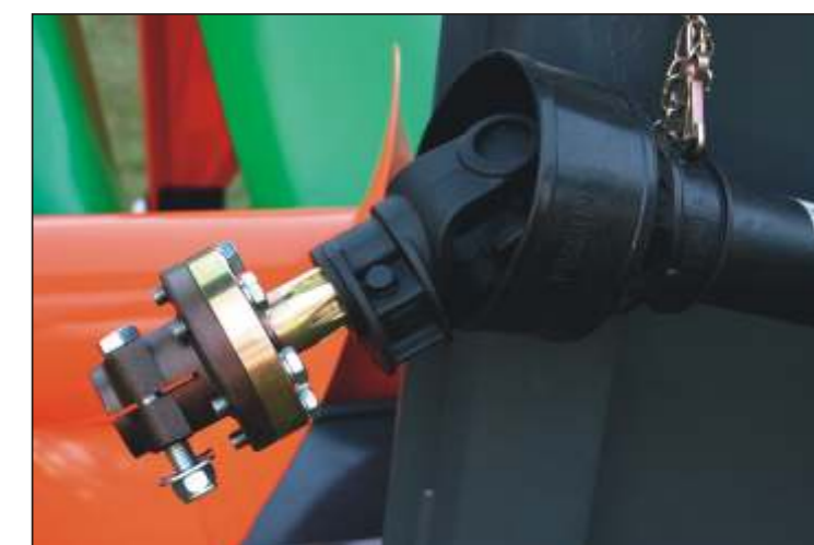
Acionamento da transmissão através de cardan universal, onde o mesmo cardan serve para todos modelos de colhedoras.
