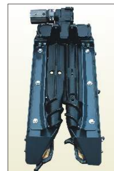
Rolos recolhadores altamente resistentes, os quais não necessitam de mancalização frontal, proporcionando o recolhimento uniforme das espigas e não tendo variação de abertura ao longo do tempo; Os rolos recolhadores possuem 6 aletas as quais proporcionam maior rapidez no recolhimento das espigas não sobrecarregando a colheitadeira com excesso de palha. Caixa de transmissão compacta, reduzindo consideravelmente o peso por linha. Lubrificada com graxa, proporciona menor necessidade de reposição. Limitadores de torque individuais por linha com sistema radial de desarme proporciona rapidez na visualização de qualquer interferência no trabalho de colheita, agilizando a mesma.
