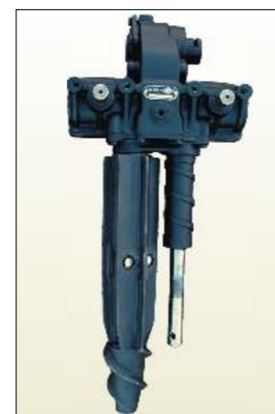
Rolos recolhadores altamente resistentes, os quais não necessitam de mancalização frontal, proporcionando o recolhimento uniforme das espigas e não tendo variação de abertura ao longo do tempo; Os rolos recolhadores possuem 6 aletas as quais proporcionam maior rapidez no recolhimento das espigas não sobrecarregando a colheitadeira com excesso de palha. Caixa de transmissão compacta, reduzindo consideravelmente o peso por linha. Lubrificada com graxa, proporciona menor necessidade de reposição. Limitadores de torque individuais por linha com sistema radial de desarme proporciona rapidez na visualização de qualquer interferência no trabalho de colheita, agilizando a mesma.
