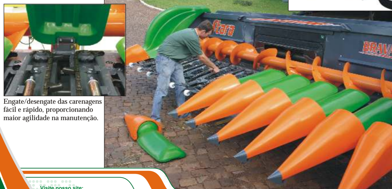
Rolos recolhadores altamente resistentes, os quais não necessitam de mancalização frontal, proporcionando o recolhimento uniforme das espigas e não tendo variação de abertura ao longo do tempo; Os rolos recolhadores possuem 6 aletas as quais proporcionam maior rapidez no recolhimento das espigas não sobrecarregando a colheitadeira com excesso de palha. Caixa de transmissão compacta, reduzindo consideravelmente o peso por linha. Lubrificada com graxa, proporciona menor necessidade de reposição. Limitadores de torque individuais por linha com sistema radial de desarme proporciona rapidez na visualização de qualquer interferência no trabalho de colheita, agilizando a mesma.
