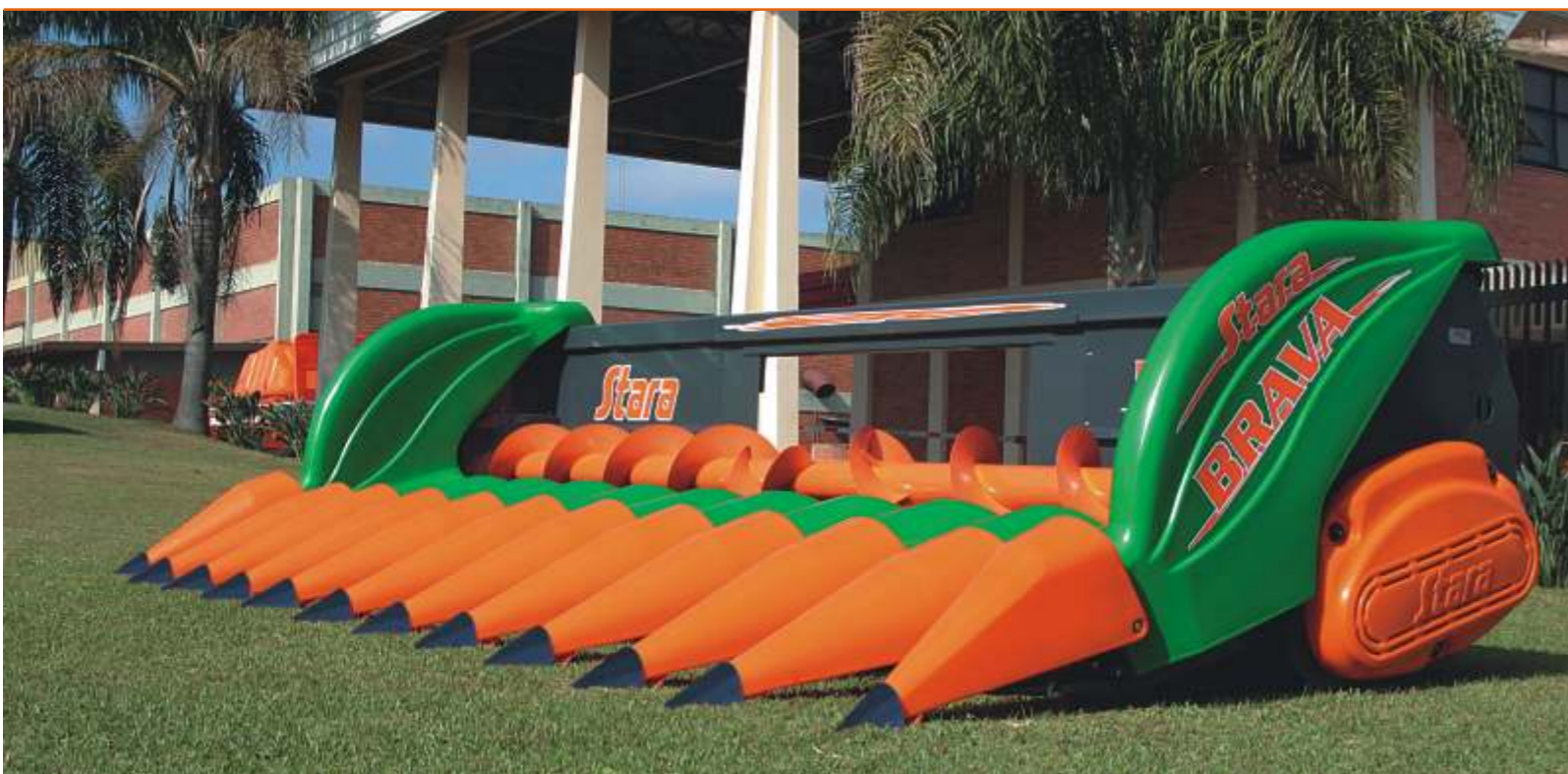
Sistema de acoplamento para qualquer modelo de colhedora, com a simples troca da estrutura de engate;
