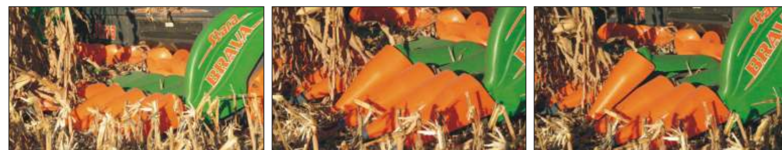
Carenagem com sistema de articulação automática que evita danos ao se chocar contra obstáculos na lavoura.
