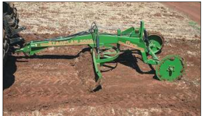
Rodas guias são especiais para construção de terraços.
