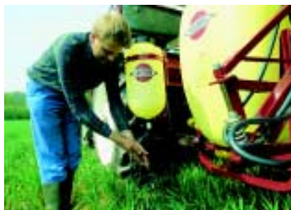
Depósito de agua limpia de 15 l
