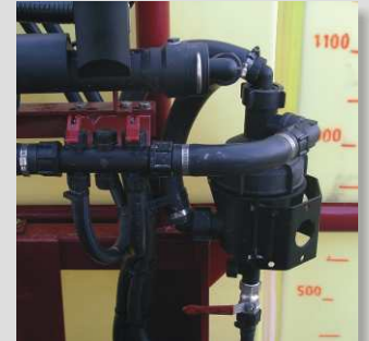
Filtro autolimpiante para evitar paradas innecesarias.
