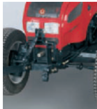
Sollevamento idraulico e presa di forza anteriore a richiesta (modelli Base)
