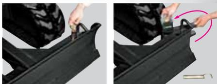
Rápida e facilmente também se ajusta a largura da lâmina buldozer retirando a cavilha e utilizando as partes laterais de suporte.
