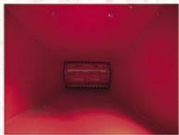
◀ A entrada da alimentação do Cyclone 8 é de 30,5 x 20 cm no rolo de alimentação, e expande até uma abertura de 94 x 68 cm na parte exterior do túnel de alimentação.
