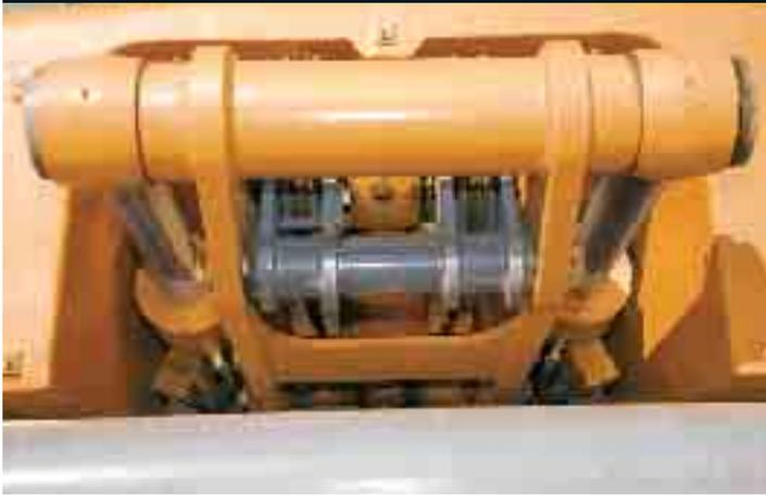
Como máquina para movimientos de tierras y trabajos pesados, la CX700B tiene una construcción robusta de pluma y balancín con placas de refuerzo en los puntos de gran tensión. El pie de la pluma está fundido para ofrecer la máxima resistencia y duración. Los balancines cortos y de serie están reforzados en el varillaje del cilindro para garantizar una total fiabilidad.
